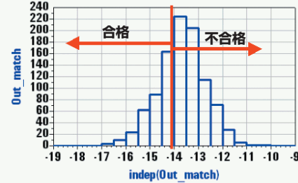
図3. 低雑音増幅器の初期(最適化後)デザインの、利得、雑音指数、出力整合に焦点を当てた歩留まり解析
